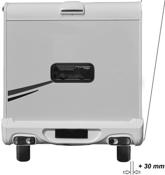
Passend für den Mercedes Sprinter ( 5-loch Ausführung) bieten wir Spurverbreiterungen in 30 mm pro Seite inkl. TÜV Teilegutachten an, die optimal auf das Fahrzeug angepasst sind.
